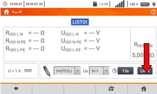
Seleccionar **Limite**, para establecer un criterio de resistencia de aislamiento permitida.
