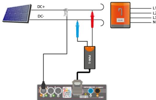
Apagar el inversor o desconectar el objeto examinado. Conectar el medidor a la cadena de módulos PV a través del adaptador PVM-1 y los adaptadores de conectores MC4. Se medirán los parámetros:
