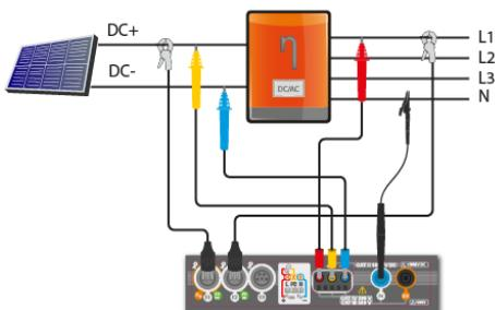
◀ En caso del inversor de 3 fases la medición se realiza en la simetría de las corrientes y tensiones de salida en el lado AC.
