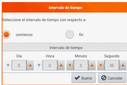
Fig. 5.20 Ajuste del inicio de alcance del análisis
