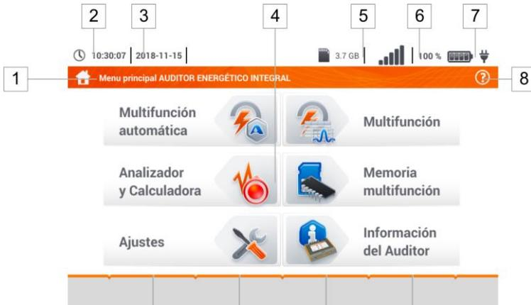
Fig. 2.1 Principales elementos de la pantalla
