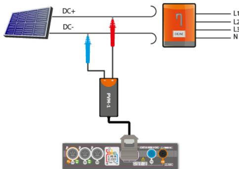
Apagar el inversor o desconectar el objeto examinado. Conectar el medidor a la cadena de módulos PV a través del adaptador PVM-1 y los adaptadores de conectores MC4. Se medirán los parámetros:
