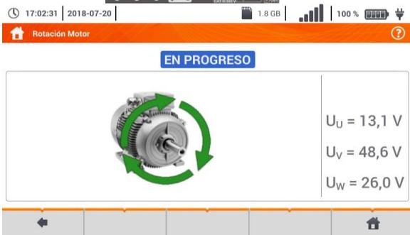
Girar las flechas en la pantalla **a la derecha** significa que el motor conectado a una red de tres fases girará **a la derecha**.
