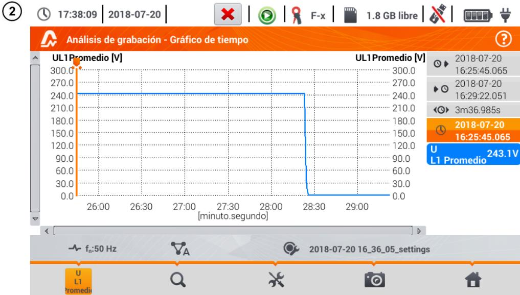
Aparece el gráfico de tiempo. Incluye: formas de onda seleccionadas en el menú **Selección de datos para el gráfico**, deslizador - indicador de valores instantáneos. El usuario puede moverlo en cualquier lugar del gráfico.
