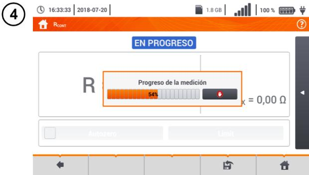
Para **deshabilitar la compensación** de resistencia de cables, repetir los pasos (2)(3) con **cables de medición abiertos**. El resultado **contendrá la resistencia de cables de medición**.
