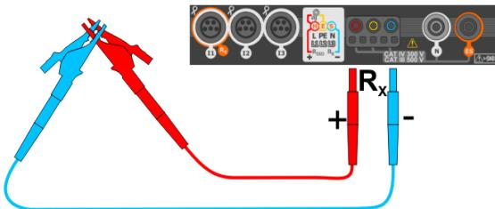
Para **deshabilitar la compensación** de resistencia de cables, repetir los pasos 2 3 4 con **cables de medición abiertos**. El resultado **contendrá la resistencia de cables de medición**.
