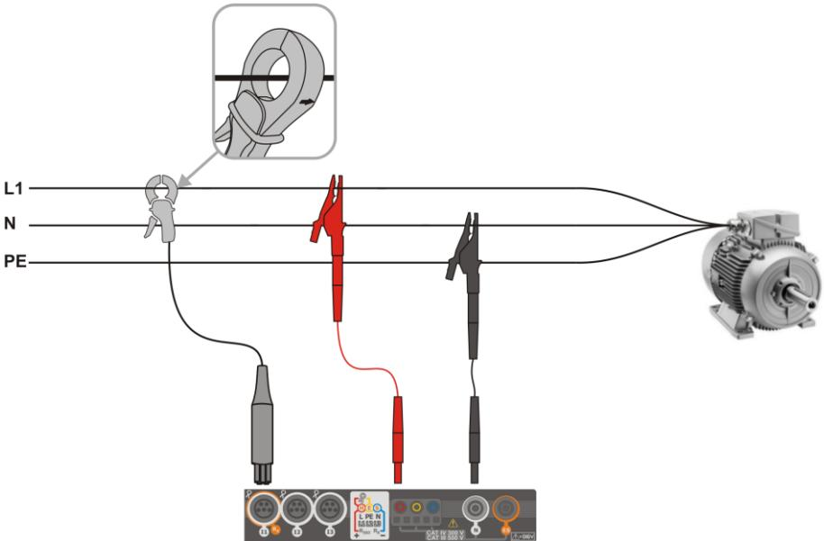
Fig. 5.4 Esquema de conexión – sistema monofásico
