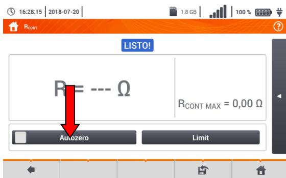
Para eliminar el impacto de la resistencia de los cables de medición en el resultado, se puede realizar la compensación (cero automático). Para ello, seleccionar **Cero automático**.
